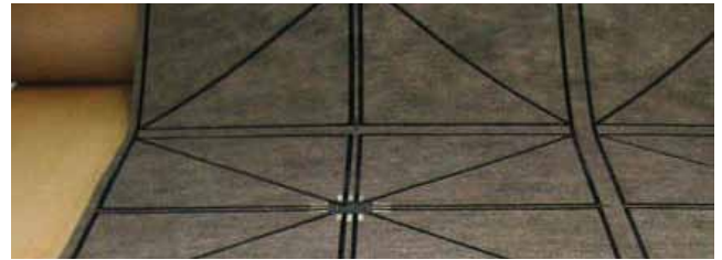
Bild Sens Floor Underlay: Die dreieckigen Sensorflächen & die Versorgungsleitungen sind in leitfähiges Vlies strukturiert
